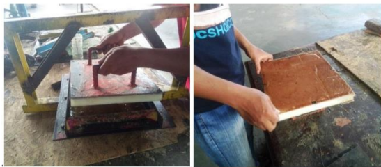
Gambar 2. Pembuatan compressed board dari serbuk kayu
