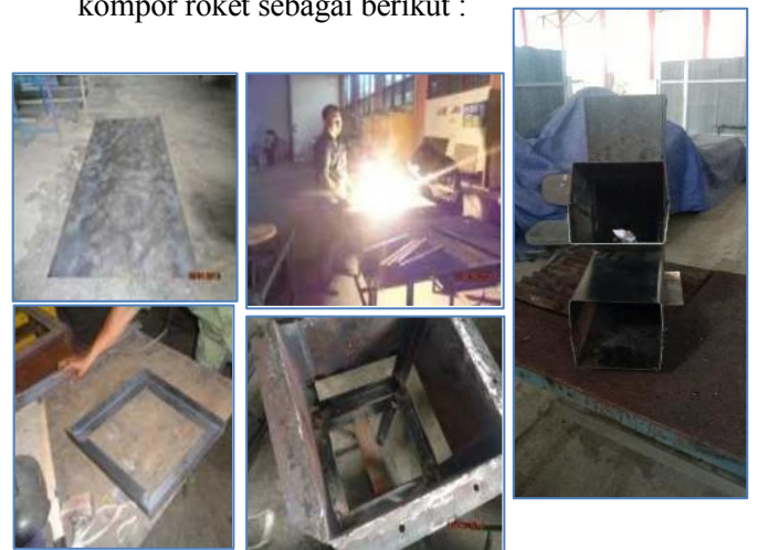
Gambar 1. Proses pembuatan Kompor roket
