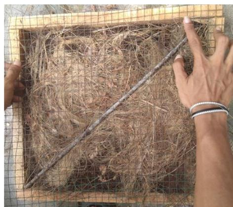
**Gambar 6.** Mall/bekisting yang telah diisi dengan sarat sabut kelapa dan diberi kawat ram.
