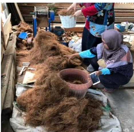
**Gambar 4.** Tim pengabdian melakukan kegiatan pendampingan untuk memproduksi sarat sabut kelapa sebagai bahan utama pembuatan panel beton pracetak.
