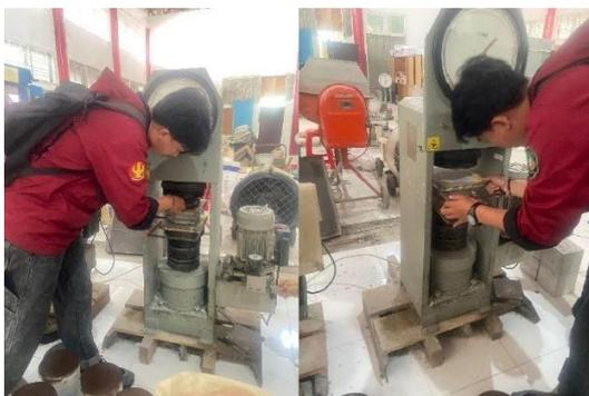
Gambar 5. Pengujian kuat tekan Paving Block
